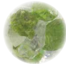
Grade 3 3,0 – 6,0 mm (entsprechend Schrot)
