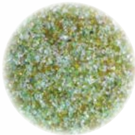
Calidad 1 0,5 - 1,0 mm (equivalente a arena de calidad 16/30)
